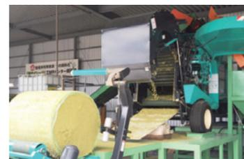
伐採した笹を円筒状に固めた後、梱包し、発酵させる
